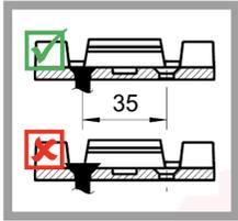
Verwenden Sie nur Senkkopfschrauben. Der Schraubenkopf darf nicht überstehen.
