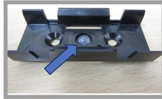
Die Leuchte kann vor ungewollter Bewegung in der Längsachse durch Elastikpuffer Ø8x3mm oder einen Tropfen Silikon gesichert werden.
