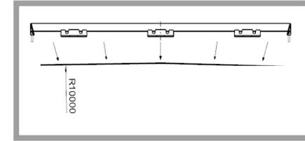
**Empfehlung:** Das Fahrzeugheck darf max. einen Radius von 10m aufweisen.
