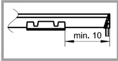
Montieren Sie die Halteklammer min. 10mm von der Außenkante.
